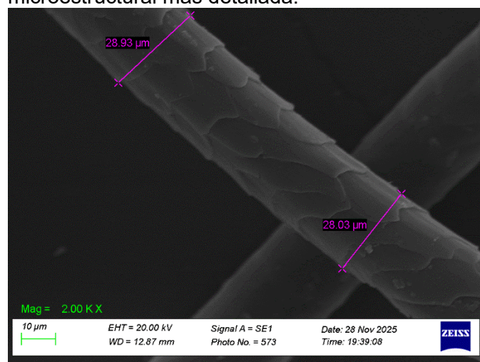
Figura 2: Micrografia eletrônica de varredura (MEV) da fibra de lã in natura da raça Crioula, utilizada para avaliação do diâmetro da fibra.
