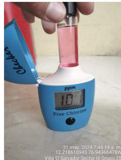
Figura 4: Cloro libre residual de la vivienda N° 2
