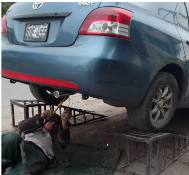
Figura 2: Filtro de escape implementando en el automóvil
